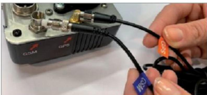
Antena se izvlači do krova vozila i pričvršćuje pomoću magneta koji se nalazi na dnu antene. Ako antena nije postavljena na krov vozila, spajaju se samo konektori.
